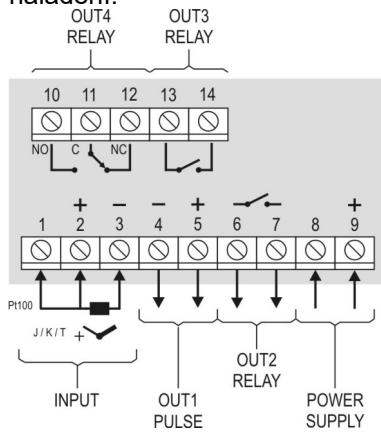
Na měřicí vstup lze připojit odporový snímač teploty **Pt100** nebo **termočlánek typu J, K nebo T**. **N1040** má jeden napěťový pulzní výstup OUT1 (pro ovládání polovodičového relé signálem PWM) a 1, 2 nebo 3 relé (OUT2, OUT3, OUT4). Výstupům může být přiřazena libovolná funkce (regulace, alarmy, diagnostika, u modelu **N1040T** i časovače). Vestavná hloubka 70 mm a odnímatelná šroubovací svorkovnice usnadňuje vestavbu do stísněného prostoru, instalaci a výměnu.
